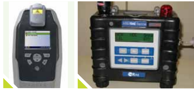
Kimyasal Analiz Cihazı (Kitle imha silahları, kimyasal silahlar, patlayıcılar, toksik kimyasallar, sıvı, katı ve toz kimyasalların saf ve karışım halinde analizini yapmakta kullanılır.)
