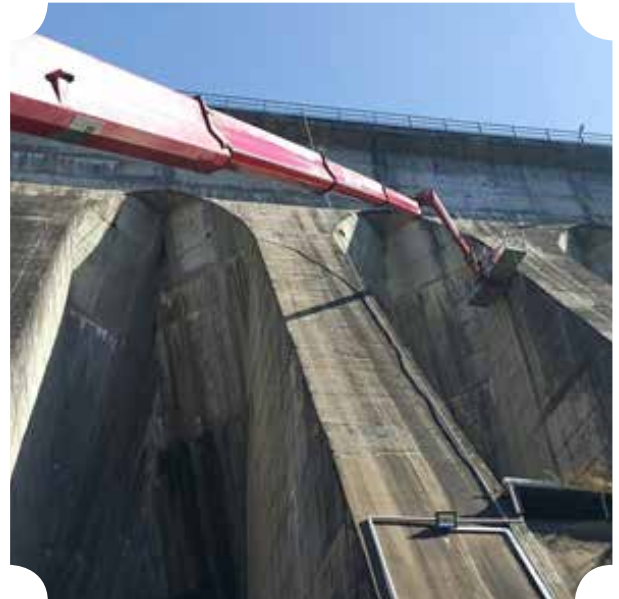
Elmalı Barajı Karot Numunesi Alımı
