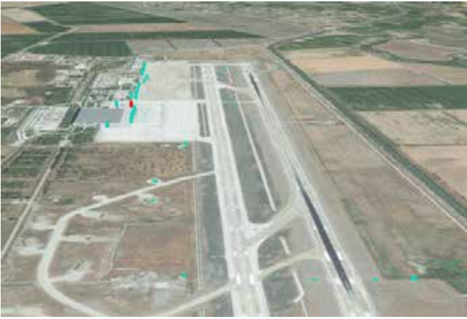
Dalaman Havalimanı manialarının AIXM 5.1 formatında 3 boyutlu görünümü
