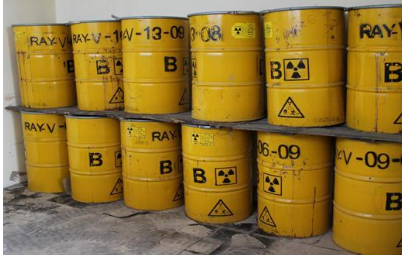
Resim 11. D1 nolu depoda bulunan radyoaktif atık içeren etiketlenmiş variller
