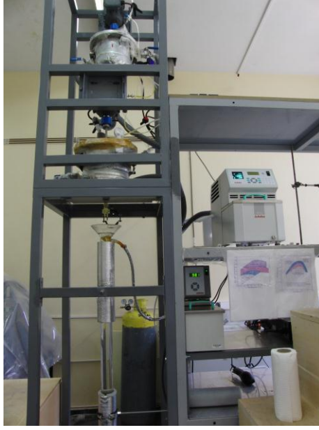
Resim 7. Yarı otomatik iç jelleştirme düzeneği ve bu yöntemle üretilen \text{UO}_2 peletleri
