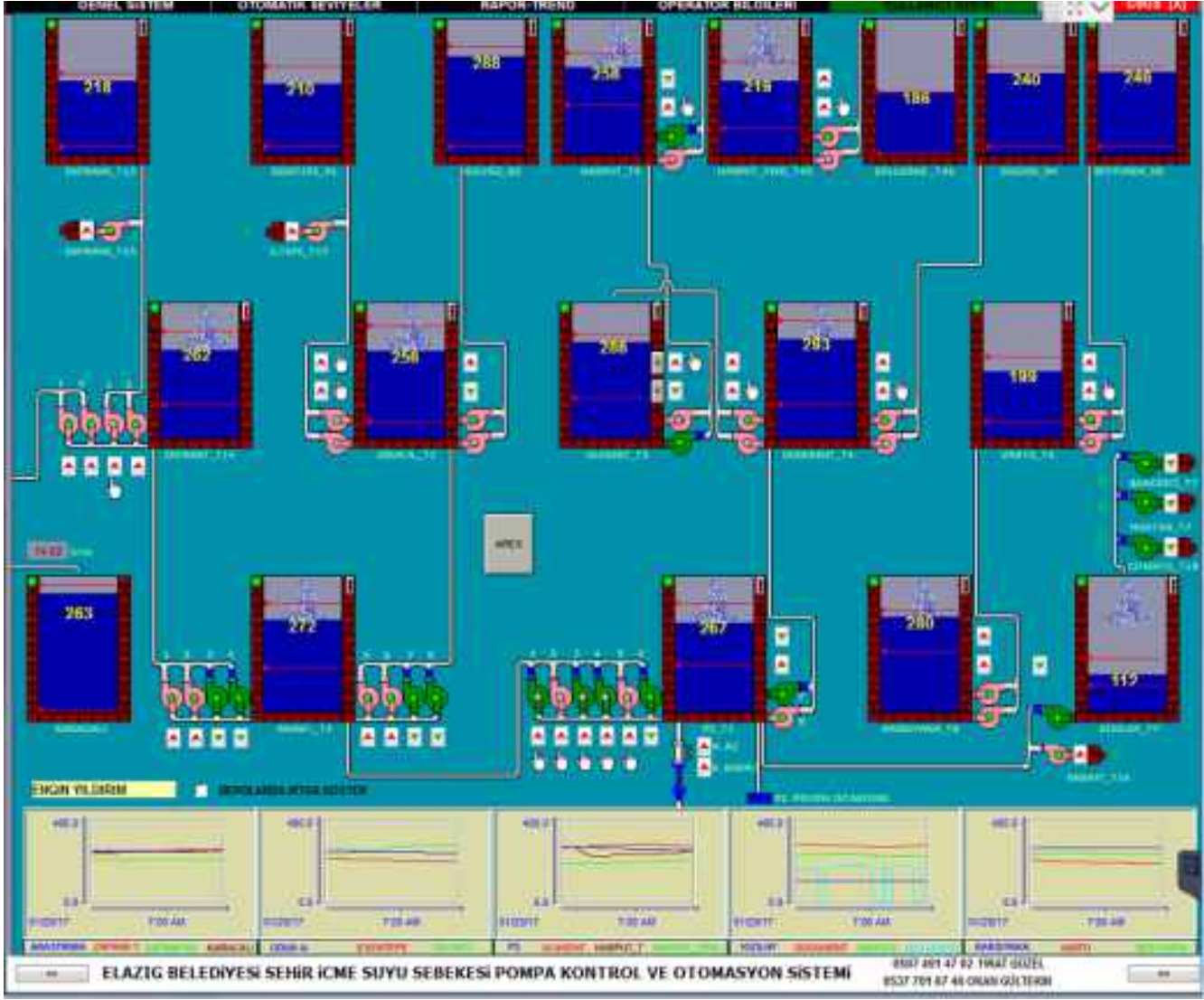
Şekil: SCADA sistemi merkez doğu bölgesi
