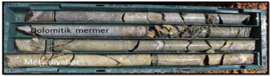
Konya-Selçuklu ruhsat sahası sondajlarına ait dolomitik mermer ve metadiyabaz seviyelerinden görünüm
