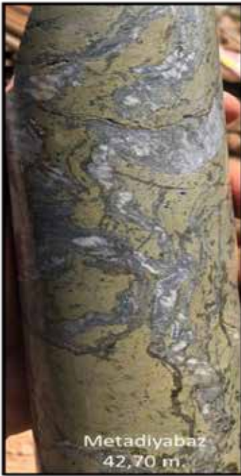
Konya-Selçuklu ruhsat sahası sondajlarına ait dolomitik mermer ve metadiyabaz seviyelerinden görünüm
