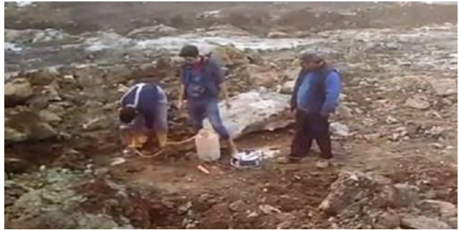
Arazide PIT (süreksizlik) deneyi
