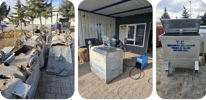
Şekil 34. Konteynerlerin bakım onarım çalışmaları ile yeniden kullanıma hazır hale getirilmesi
