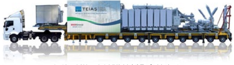
154/33.6 kV, 35/50 MVA Mobil Trafo Merkezi
