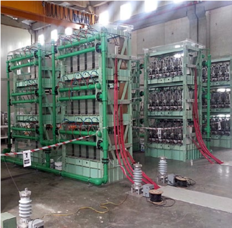
YGDA Projesi kapsamında geliştirilen 10 MVA gücünde prototip
