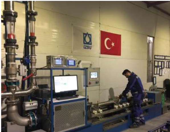
Sayaç Atölyesi Test İşlemleri
