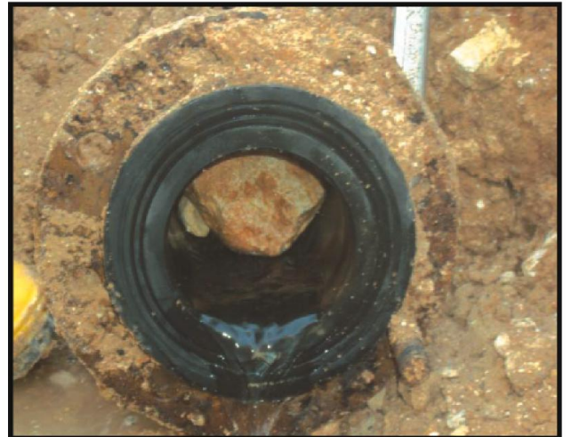
Yukarıdaki resimde Yenimahalle 5326 sokakta 100'lük pik boruda muf bağlantısındaki kurşun atmıştır. Arıza bağlantı yerine kurşun çakılarak giderilmiştir.
