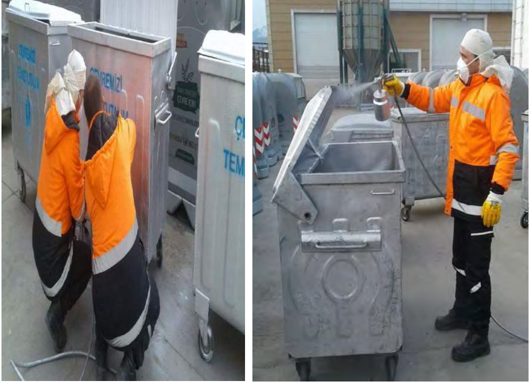
Konteyner Tamir Bakım ve Onarım İşlemi
