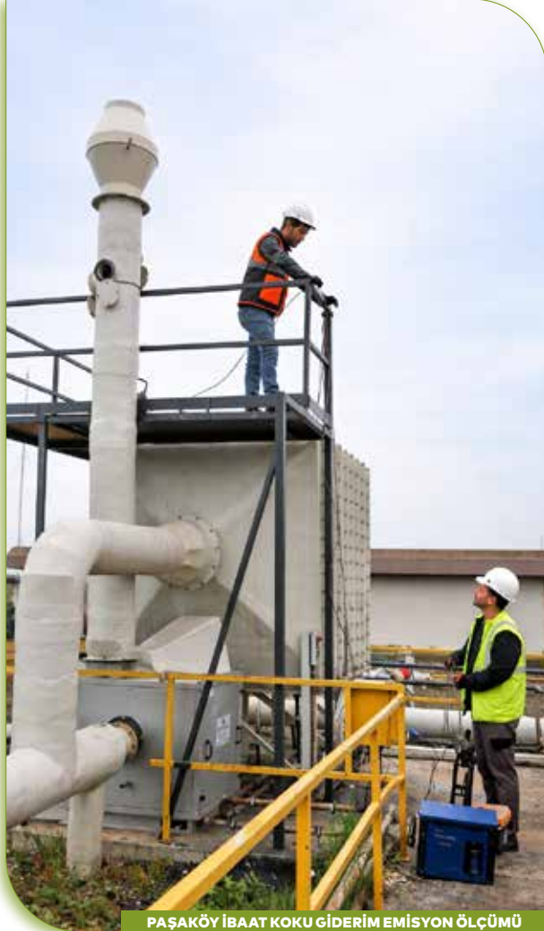
PAŞAKÖY İBAAT KOKU GİDERİM EMİSYON ÖLÇÜMÜ
