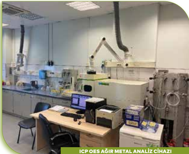
ICP OES AĞIR METAL ANALİZ CİHAZI
