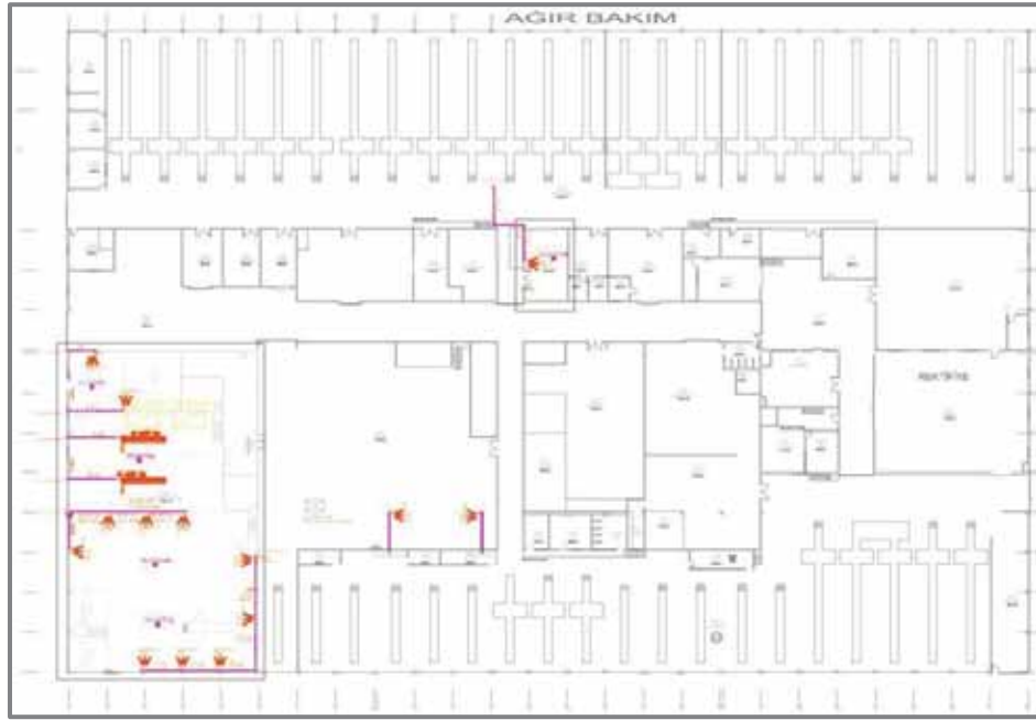
Karoser Atölyesi Atölyesi 2'inci Etap Radyant Isıtma Sistemi Projesi
