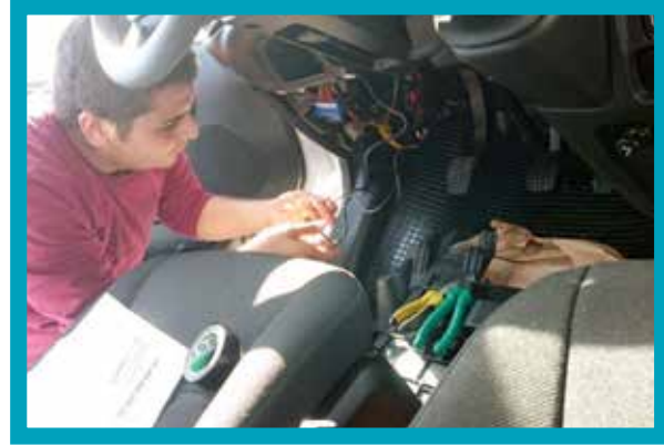
Taşıt Tanıma Sistemi Montajı
