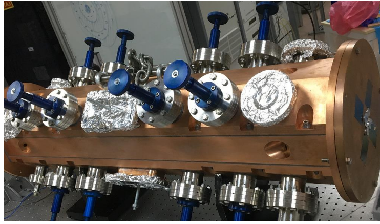
Resim 19. Tuner, vakum portları ve RF coupler (bağdaştırıcı) bağlantılarının RFQ'ya monte edilmiş görüntüsü
