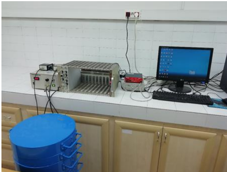
Resim 7. 4\pi - \beta - \gamma birincil standart radyoaktivite sayım sistemi
