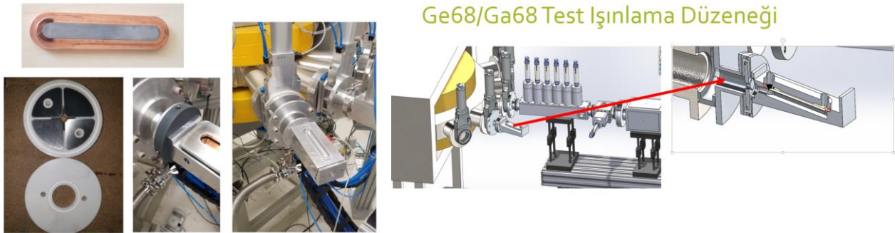
Resim 22. Kaplanmış hedef ve test ışınlama düzeneği
