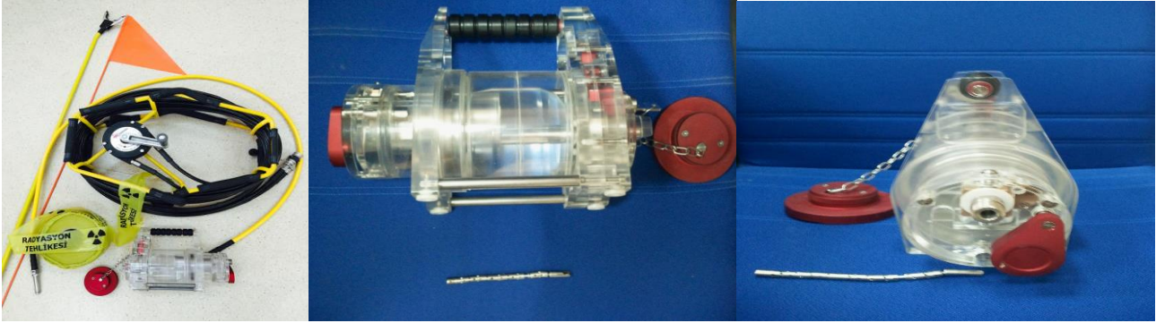
Resim 6. Endüstriyel radyografide radyasyondan korunma eğitiminde kullanılan demo ekipmanları
