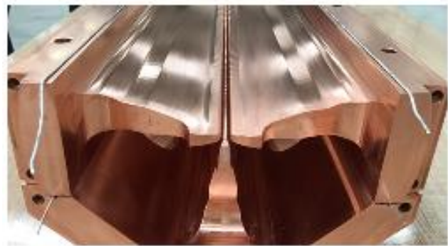
Resim 17. Kanatlar arasına İndiyum tel yerleştirilmiş görüntüsü
