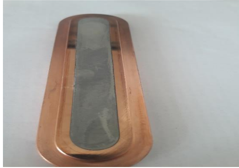
Resim 25. GaNi alaşım kaplanmış bakır hedef taşıyıcı
