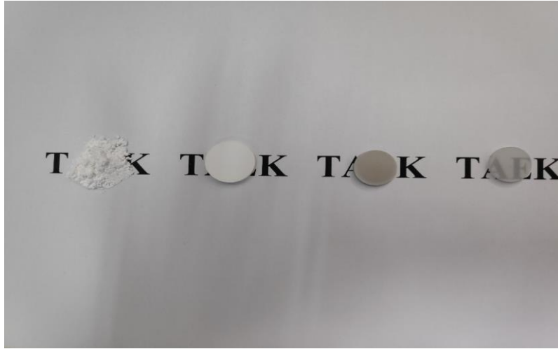
Resim 28. Sentezlenen tozlar ile şekillendirme, sinterleme ve HIP işlemleri sonrası elde edilen diskler
