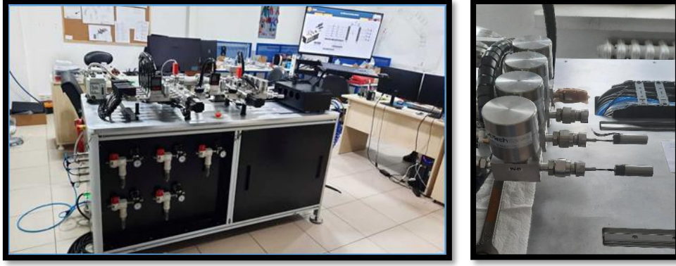
Resim 41. Yüksek vakumlu gaz doldurma/otomatik kontrol sistemi tüp bağlantısı.
