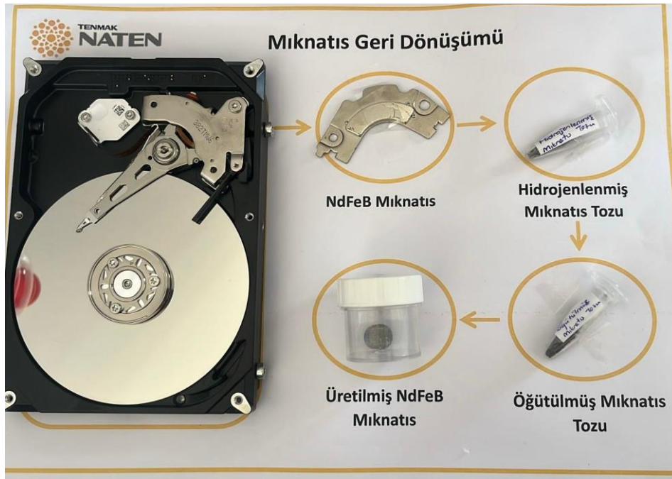
Resim 44. Elektronik atıklardan kalıcı mıknatıs geri dönüşüm çalışmaları
