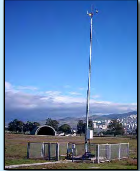
Resim 4- Havaalanı otomatik meteoroloji gözlem ve raporlama istasyonu
