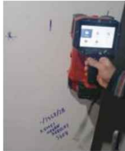
B. Röntgen Cihazı İle Donatı Tespiti
