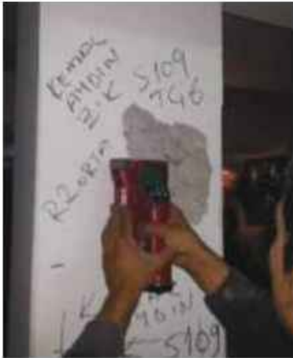
B. Röntgen Cihazı İle Donatı Tespiti
