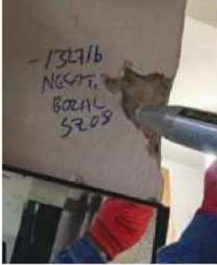
A. Schmidt Çekici İle Beton Dayanımı Tespiti
