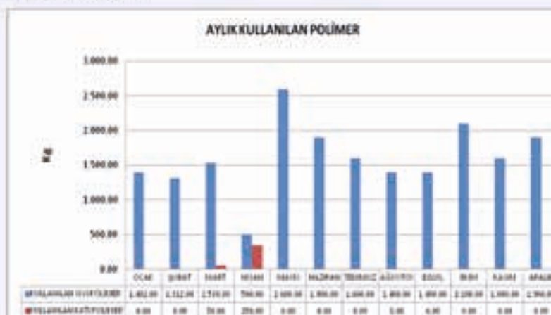
Arıtma Çamuru; Tesismizden 2011 yılında 2.380 ton %20-%23 kuruluk oranında, kuru katı maddeli arıtma çamuru (Biyokati) çıkmıştır. Şekil - 6' da arıtma çamurunu katı halde çıkarabilmek için ne kadar kimyasal madde (Katyonik Polielektrolit) kullanıldığı görülmektedir. Bu grafik işletmenin hangi aylarda, kimyasal maddeye fazlaca ihtiyaç duyduğunu göstermektedir.
