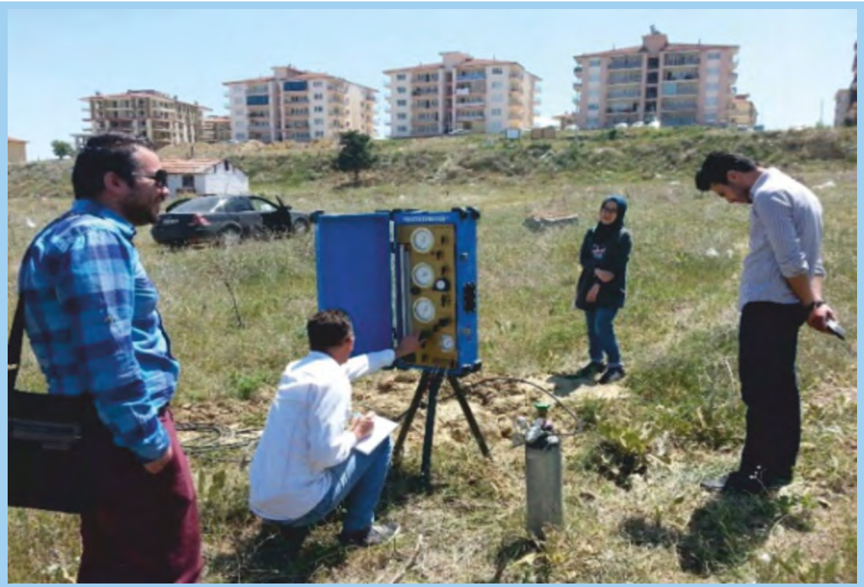
Şemikler Mahallesi pressiyometre deneyi
