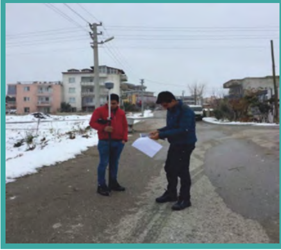
Gümüşçay Mahallesi '0' kotunun kontrol işlemi
