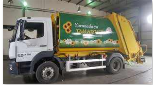
14 Metreküp Kapasiteli Hidrolik Sıkıştırılmalı Çöp Kamyonu
