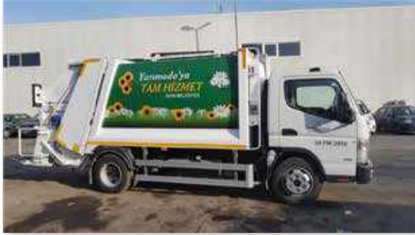
8 Metreküp Kapasiteli Hidrolik Sıkıştırılmalı Çöp Kamyonu
