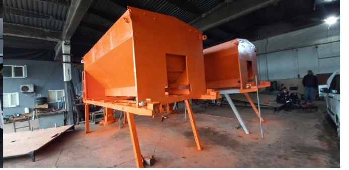
Tuzlama ekipmanlarının revizyonu ve sıfırdan imalatı
