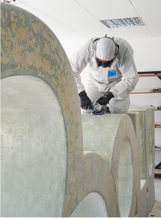
EPS (strofor) kesim, akrilik+kalsit püskürtme kaplama "Sandallar Mahallesi" yazısı
