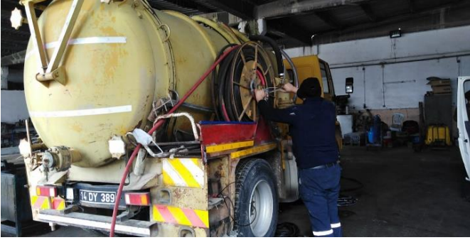
Kanalizasyon işleri vidanjör bakım onarımı
