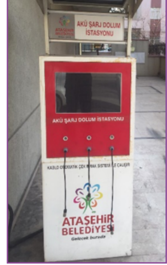
Akü Dolum İstasyonu
