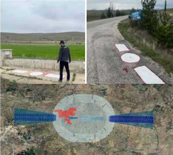
(Gümüşhane-Bayburt Havalimanı Mania Tespiti Yer Kontrol Noktası Tesisi)
