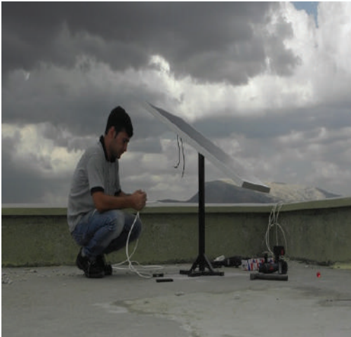
Resim 3-4. Güneş Panelli Depo( 12 V) Otomatik Klorlama Sistemi
