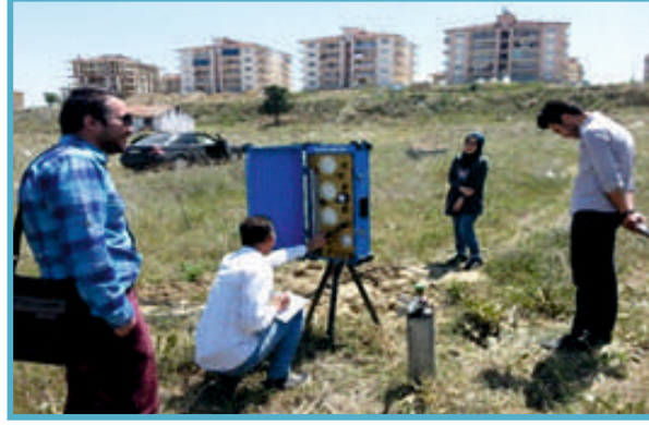
Şemikler mahallesinde yapılan pressiyometre çalışması
