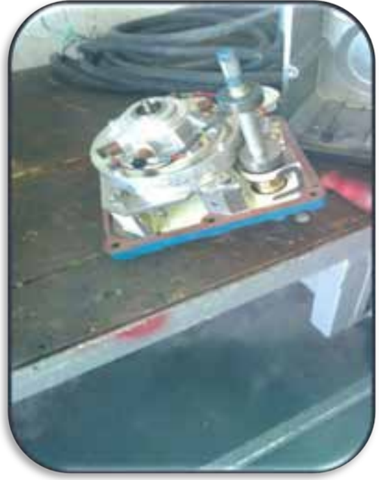
Biyogaz jeneratörü trotle valf arızası giderildi, ayarları yapıldı.
