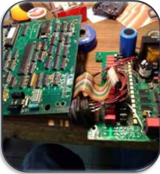
Biogaz Jeneratörü ateşleme kartı arızası giderildi.
