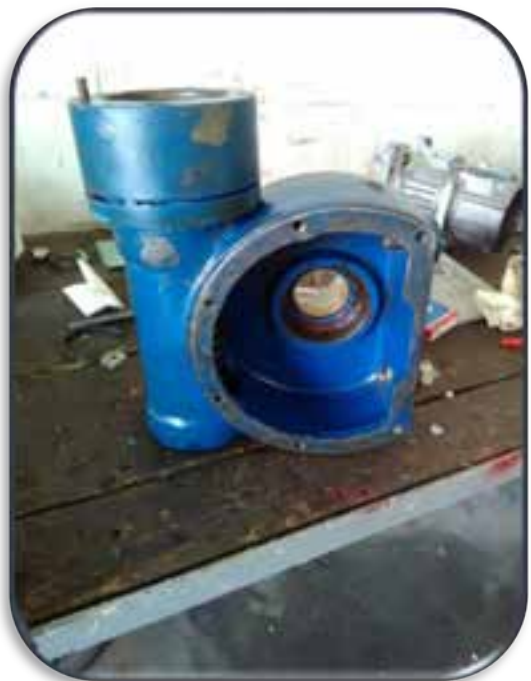
II. Kademe Atıksu Arıtma Tesisi auma vana rulmanları değiştirildi.
