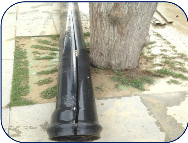
Atatürk Caddesinde Meydana Gelen Arızada 6 Metrelik Ø160' lık PVC Borunun Görüntüsü
