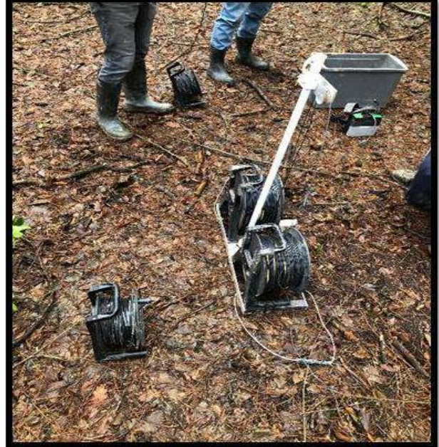
İdaremize Ait İR:2017/01 Ruhsat Sahasında Yapılan DES (Düşey Elektrik Sondajı) Çalışmaları
