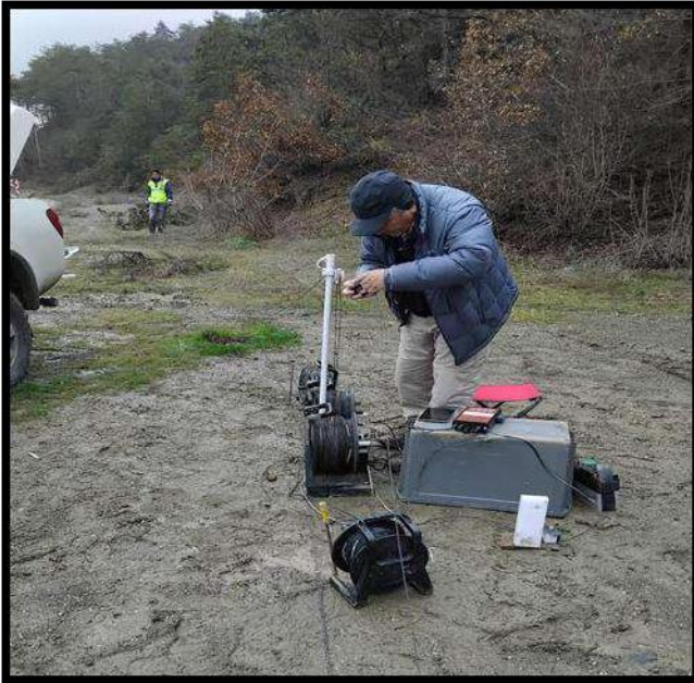
İdaremize Ait İR:2017/01 Ruhsat Sahasında Yapılan DES (Düşey Elektrik Sondajı) Çalışmaları
