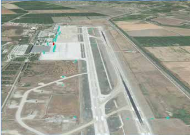
Dalaman Havalimanı için AIP'de yayımlanan mania bilgilerinin AIXM 5.1 formatında 3 boyutlu görünümü
