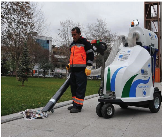
%100 elektrik ile çalışan vakumlu süpürge makinesi.
