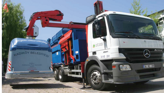
3,2 m 3 hacimli yer üstü konteyneri boşaltım işlemi
