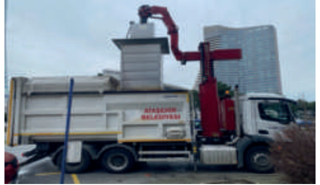
Yer Altı Çöp Konteynerlerinden Çöplerin Toplanması Ve Taşınması
