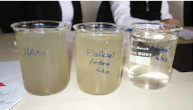
Şekil 262. Soldan Sağa; Giriş Ham Atıksu, Fiziksel Arıtma Sonrası ve Deşarj Edilen Nihai Çıkiş Suyu
