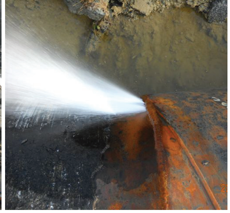
Terkos - Kâğıthane Ø 2200 mm Çelik Boruda Meydana Gelen Heyelan Deformasyonları ve Arıza Tamiri
