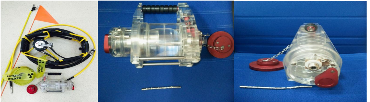
Resim 10. Endüstriyel Radyografide Radyasyondan Korunma Eğitiminde Kullanılan Demo Ekipmanları
