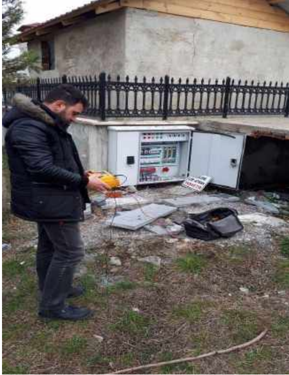
Havuzlarda Topraklama Ölçümü yapılmasına ve Havuz Uyarı Tabelası yerleşimine örnek fotoğraflar
