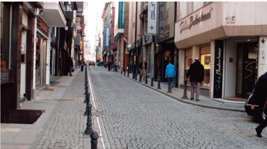
Trafiğin rahat seyri için yol kenarlarına park etmeyi önlemek için demir elemanlar yerleştirildi.
