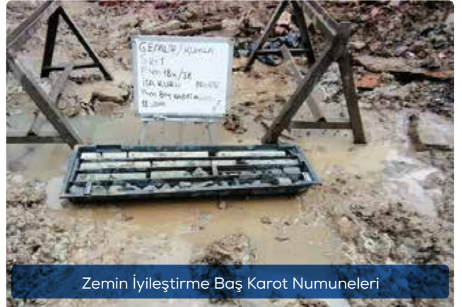
Zemin İyileştirme Tam Boy Karot Testi Alımı
