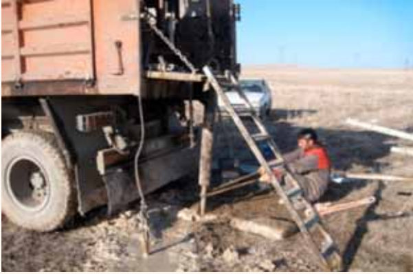
Şekil 21. Arazide SPT Çalışmalarından Bir Görünüm
