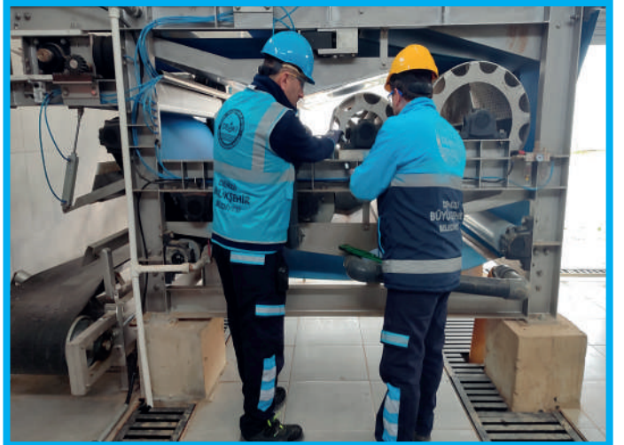
Belt Press Tambur Sistemi Bakımı
